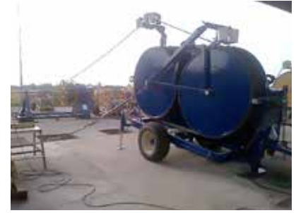
Freineuse pour déroulage par hélicoptère à 20 km/h et système de sécurité à 4 niveaux
