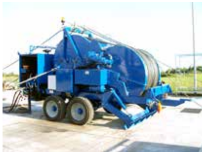
Tireuse-freineuse double circuit avec cabestans Ø 1,8 m pour conducteur HTLS
