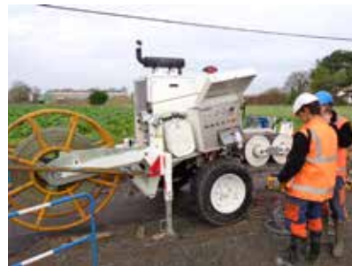
Le Concept « Dual Machine » pour les opérations de déroulage à la fois de lignes souterraines et aériennes.
